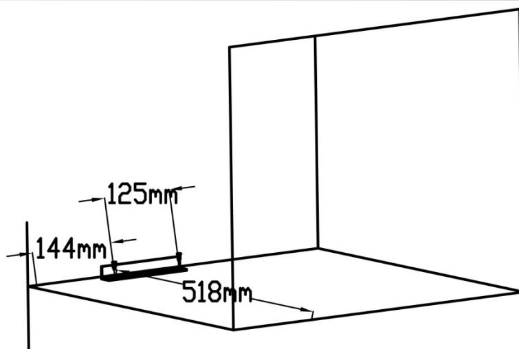
3. Voor inbouw in een keukenblok de meegeleverde plaatbevestiging met spaanplaatschroeven (4x15) bovenop het apparaat vastschroeven.
