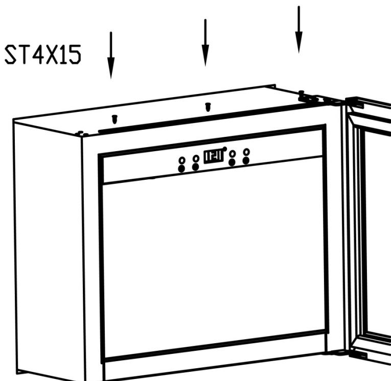
4. Het apparaat in de inkeping schuiven. Laat daarbij 26 mm ruimte tussen het corpus en de voorkant van de deur.
