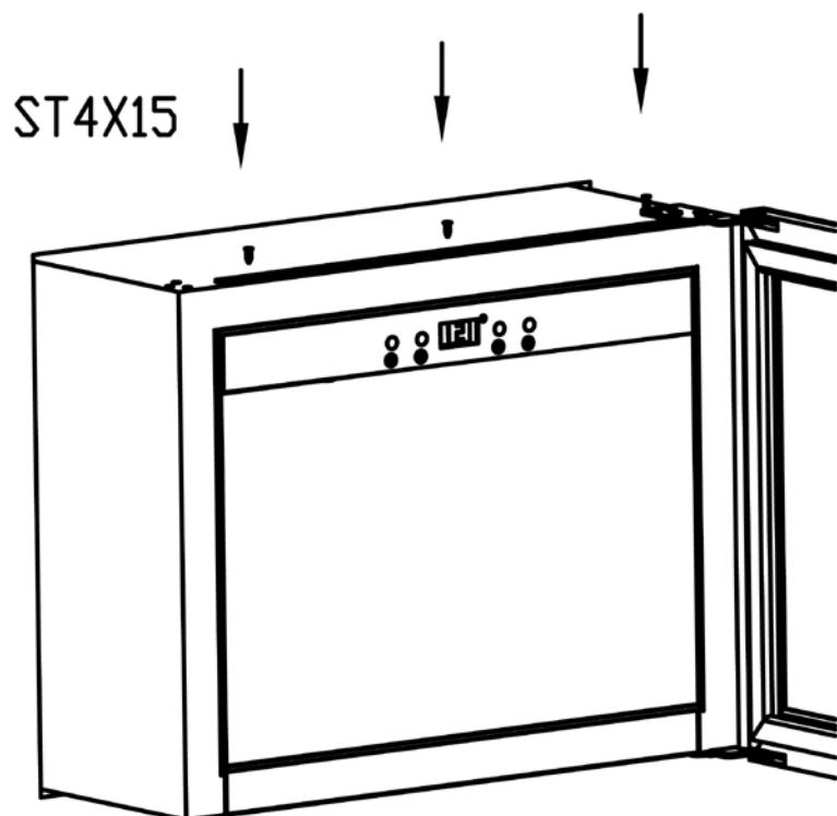
4. Gerät in die Vertiefung schieben. Dabei 26 mm Platz zwischen dem Korpus und der Türvorderseite aussparen
