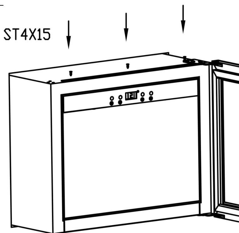
4. Inserire il dispositivo nella sede. In tale operazione tenere conto di uno spazio di 26 mm tra il corpo e il lato anteriore della porta.
