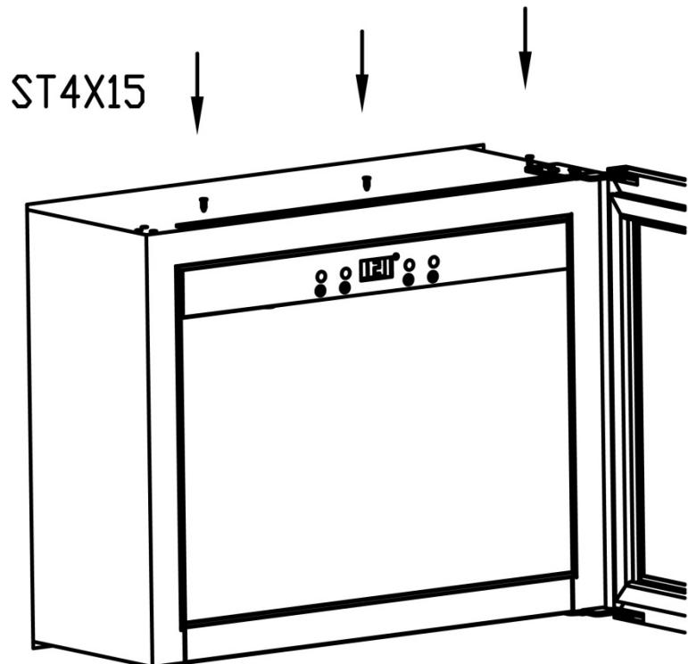
4. Pousser l'appareil dans la cavité. Il faut laisser 26 mm entre le corps et la façade de la porte
